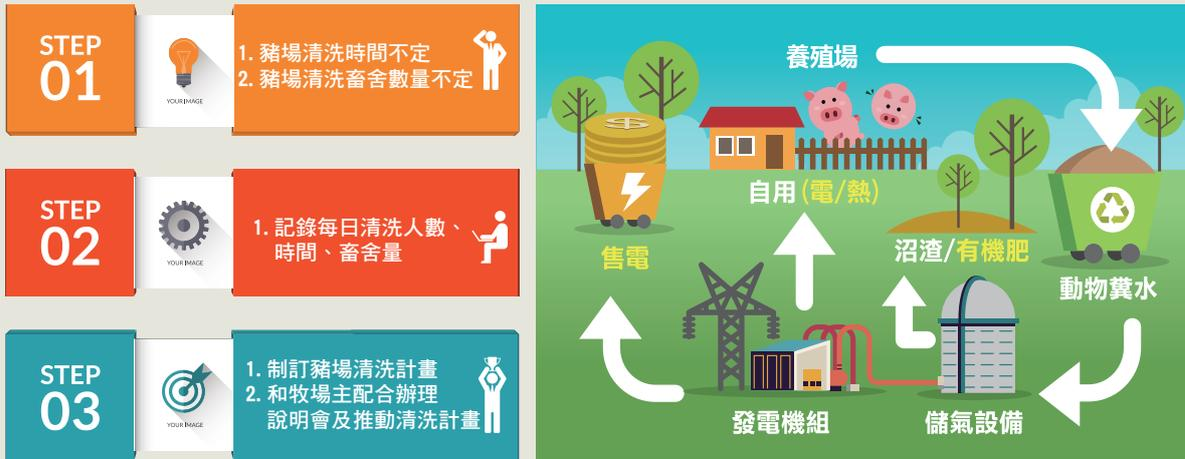
因牧場清洗時間與用水量不定，造成料源不穩定而影響沼氣量，推動沼氣發電優化計畫。從牧場管理至系統流程改善，建立牧場清洗標準流程進而與牧場檢討並做教育訓練，訂定牧場清洗時間欄舍數量並控制用水量，邁入優化沼氣發電效益。可節省水費(含隨水增收污水處理費)，污水處理流程穩定，豬糞料源固定又可使沼氣發電量穩定增加固定收入，並建立低成本的污水處理模式供小畜農場選用，解決小農的問題又可解決環境問題。更可作為綠電憑證使用，發揮沼氣發電具有創效、節能、安全和環保等顯著優勢。依環保署畜牧糞尿管理創新作法資料，每頭豬日產 $0.1M^3$ 沼氣，每 $0.7M^3$ 沼氣可產1度電，本案2,000頭豬可日產286度電，一年約104,286度電，以2018年躉售費5.0161元/度計，沼氣發電可獲523,109元/年之發電利益。
