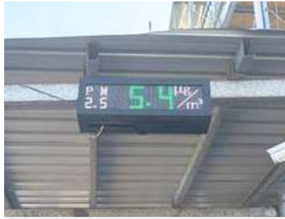
設置空氣品質監測及感測顯示器
